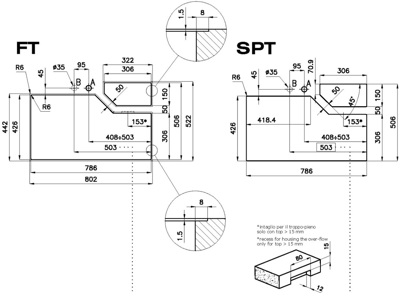
Quota max per piletta automatica / Max quote for automatic drain
